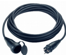
3G2,5mm². CONEXIÓN SCHUKO 16A Potencia Máxima 3,8KVA; Long.: 10, 20, 50 y 100 metros.
