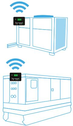
Añade un módulo DSE de control remoto que permite controlar, monitorizar y geo-localizar el grupo electrógeno o enfriadora en tiempo real a través de la aplicación web DSEWebNet (iOS App, Android App o Web App):
