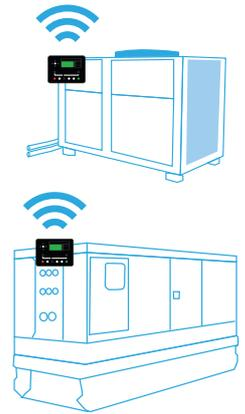
Añade un módulo DSE de control remoto que permite controlar, monitorizar y geo-localizar el grupo electrógeno o enfriadora en tiempo real a través de la aplicación web DSEWebNet (iOS App, Android App o Web App):
