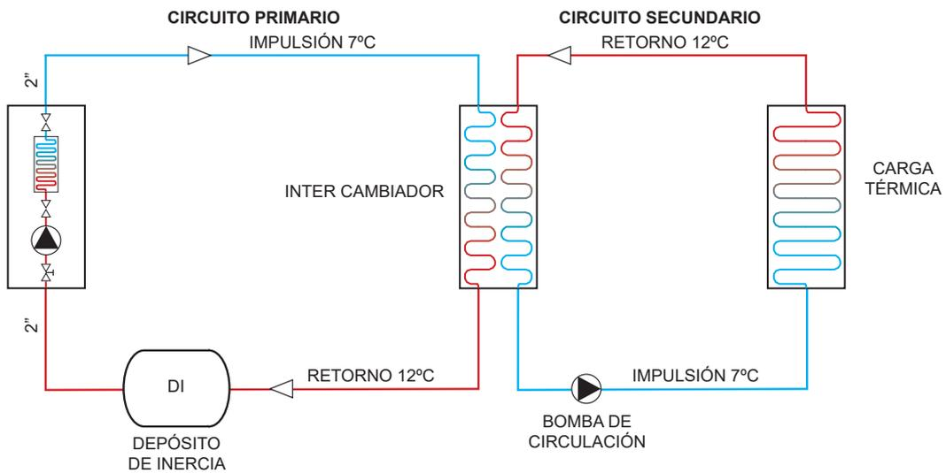
INSTALACIONES DE ENFRIADORAS DE AGUA DOS CIRCUITOS UNIDOS POR UN DEPÓSITO
