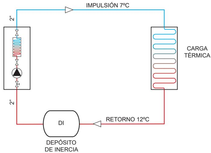
INSTALACIONES DE ENFRIADORAS DE AGUA DOS CIRCUITOS SEPARADOS POR UN INTERCAMBIADOR
