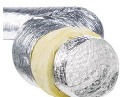
**Características:** Conducto flexible aislada construida interiormente por un conducto flexible con alma de acero y envuelta con lana de roca de 25mm de espesor y envolvente exterior en PVC anticondensación y autoextinguible.
