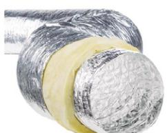
**Características:** Conducto flexible aislada construida interiormente por un conducto flexible con alma de acero y envuelta con lana de roca de 25mm de espesor y envolvente exterior en PVC anticondensación y autoextinguible.
