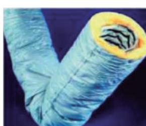
**Características:** Conducto flexible aislada construida interiormente por un conducto flexible con alma de acero y envuelta con lana de roca de 25mm de espesor y envolvente exterior en PVC anticondensación y autoextinguible.
