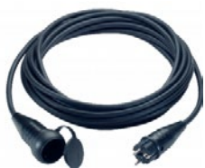
3G1,5mm². CONEXIÓN SCHUKO 16A Potencia Máxima 3,8KVA; Long. 10, 20, 50 y 100 metros.
