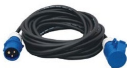
3G4mm². CONEXIÓN CETAC CEE 16A 2P+T Potencia Máxima 3,8KVA; Long.: 10, 20, 50 y 100 metros.
